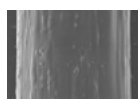
海:ポリアミド 島:ポリエステル 海島構造の表面画像 Sea: polyamide Islands: polyester Surface image of sea-island structure
